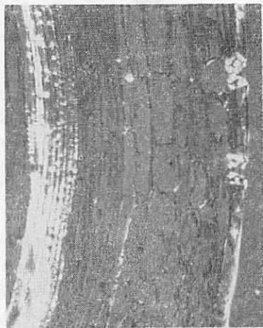
図2 マツの通導組織の偏光顕微鏡写真：光っているのがセルローズの層
