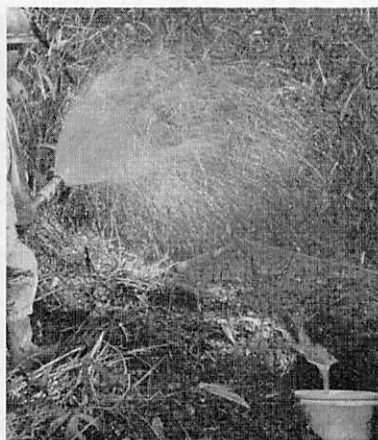
水かけ試験によって林床の根系の土壌流乏量を測定する
