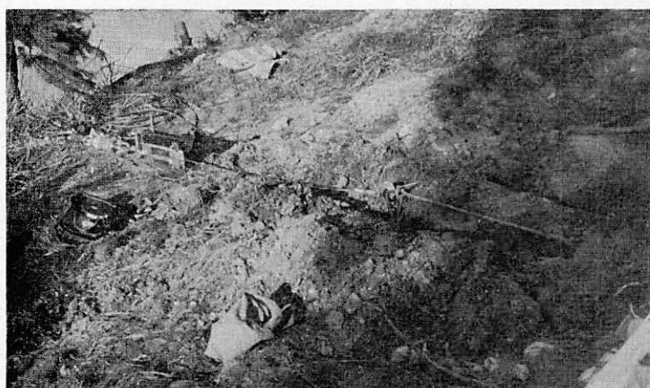
林床の根系の土壌緊縛力を測定する
