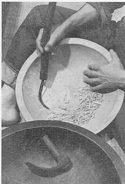
▲秋山郷の櫛の木鉢づくりの道具 手じょんな（下）と まえがんな（上） 桶屋の割鉋と鉋 大小のカーブした鉋を桶の径に合わ せて使いわけ
