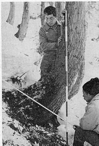
写真：3・4 根元曲がりの測定
