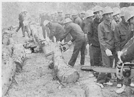
写真・2 各種防振段階のチェンソー（目立ての良否による防振鋸断能率の体得）
