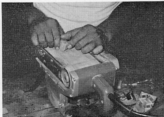
写真・4 ベルトサンダーで加工する
