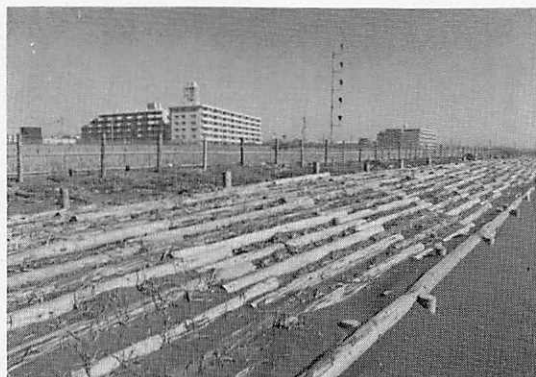
間伐材の利用開発試験 (イカダ的構造物により海岸砂地の安定化を図る)
