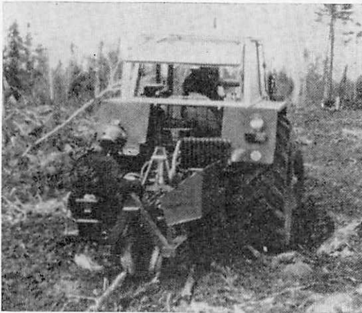
写真・5 苗木植栽機クイックウッド (オーストリア, Can. For. Ind. 1985)
