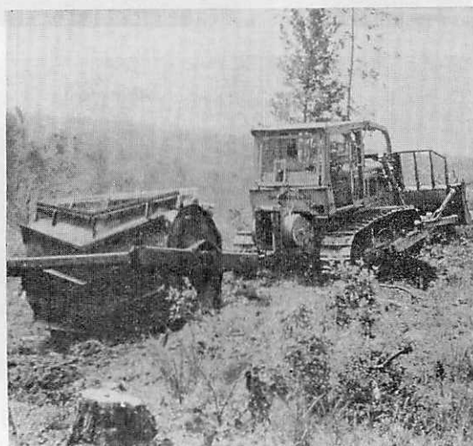
写真・1 末木枝条を踏みつぶすローリングチョッパー (アメリカ, For. Ind. 1980)
