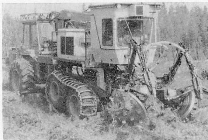
写真・7 ポット苗自動植栽機シルバノバ (スウェーデン, Wor. W. 1983)
