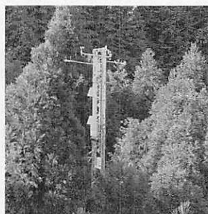
森林蒸発散量の観測タワー (笠間営林署管内)
