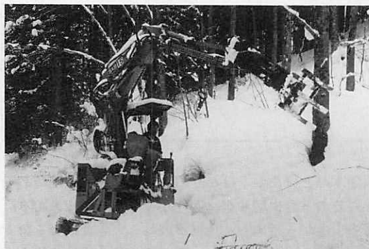
写真・1 独自に改造したミニグラップル
