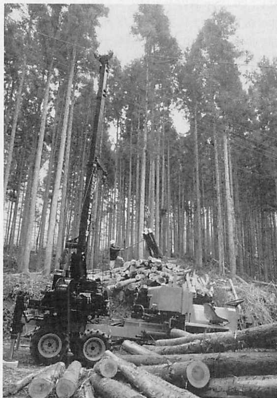
写真・4 ホイール式小型林内作業車をベースマシーンとしたモービルタワーヤード
