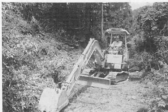
写真・3 標準バケット容量0.16 m 3 の ひと回り大きいバックホー
