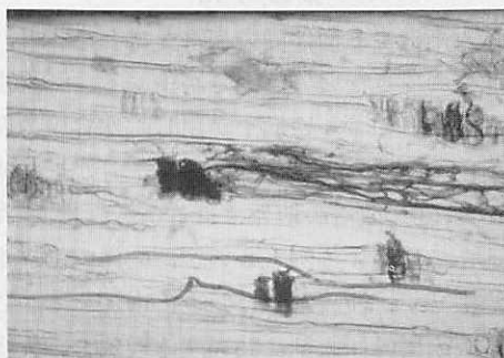
写真・8 樹幹注入剤施用木異常部分の変色部接線方向切片 (菌糸の充満が見られる)
