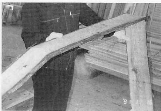
写真・2 横断もめ板は簡単に折損
