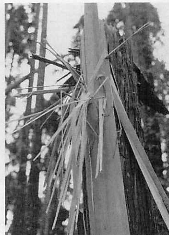
写真・6 3.5mの所で剪断。年輪層がバラバラとなっている
