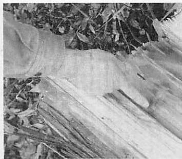
写真・4 内部まで亀裂が見られる
