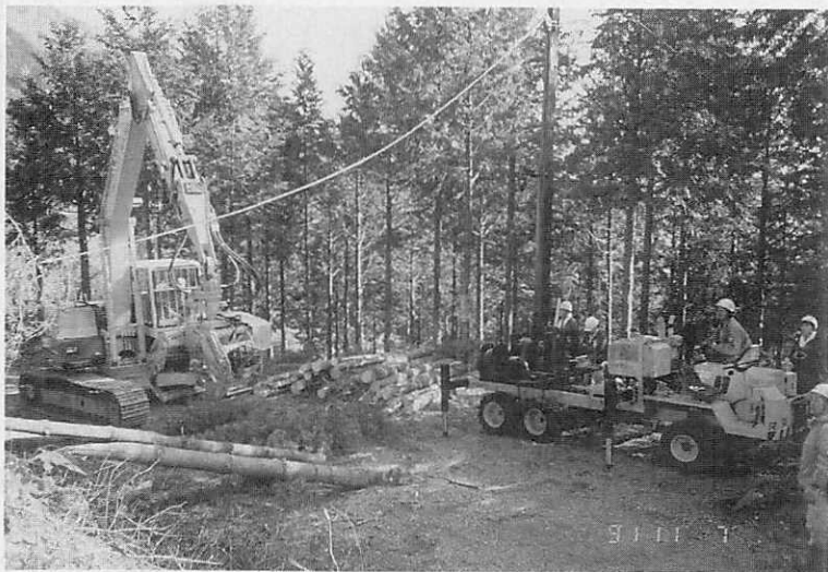
写真・1 タワーヤードとプロセッサによる間伐作業
