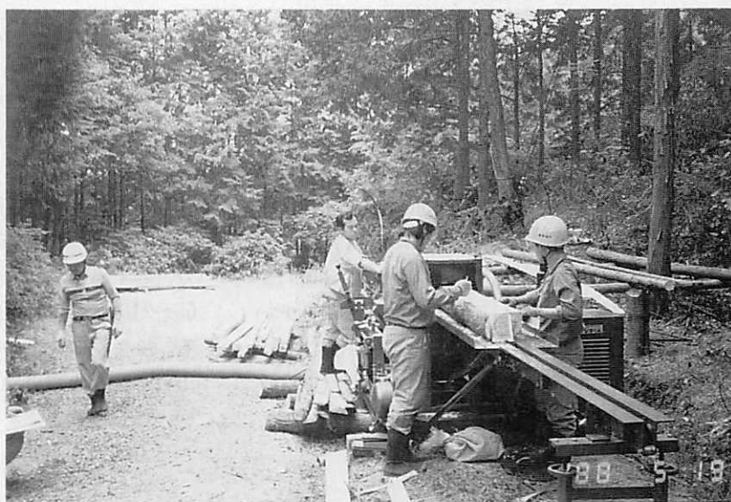
写真・1 「道端製材」移動式製材機“かくびきくん”
