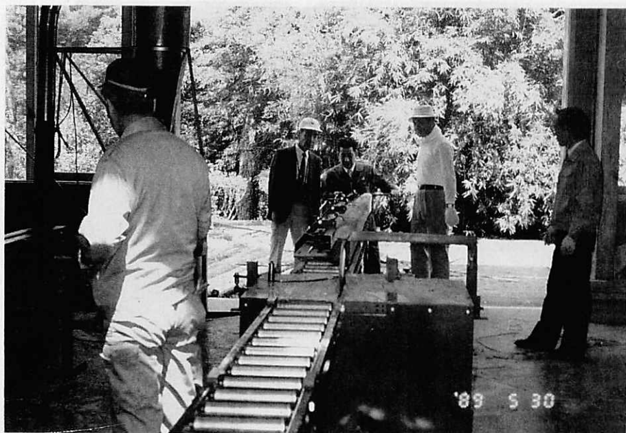
写真・5 建物内における 万能小型テーブル盤 (エンジンタイプ)
