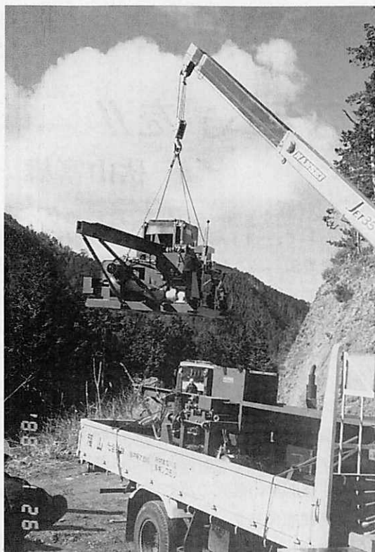
写真・2 クレーンによる移動式製材機の据付け
