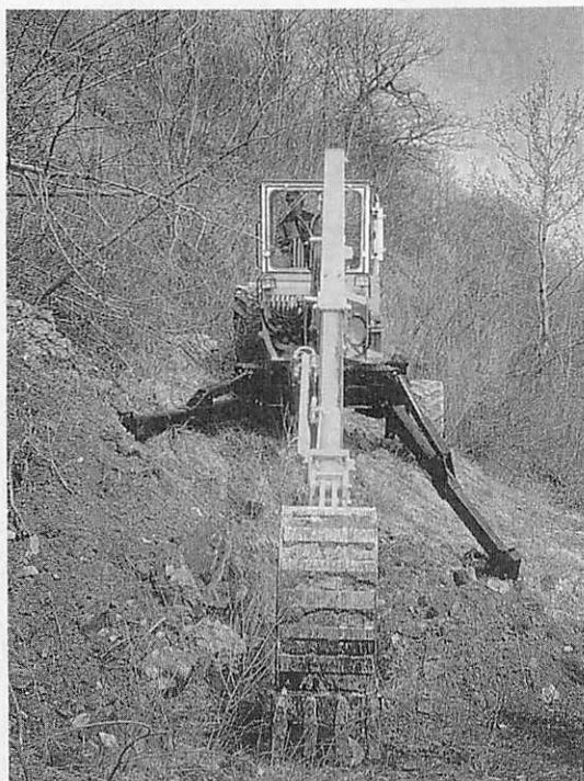
写真・1 脚と車輪の複合型機械 Menzi Muck
