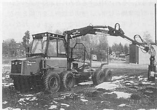
写真・3 フォーワードに取り付けた小型一体型植栽作業ユニットの実験機(実験機の大きさは直径約35cm、高さ約80cm、重量約70kg)
