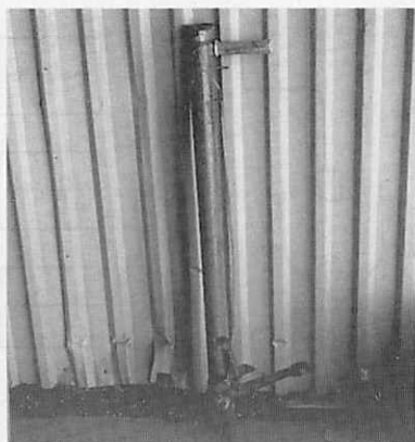
写真・2 植栽チューブ(チューブ下端の嘴を土中に差し込み、嘴脇のペダルを踏んで嘴を開いて植え穴を開け、苗をチューブ上端の口から落とし込んだ後でチューブを抜き、苗周囲を踏みしめる)
