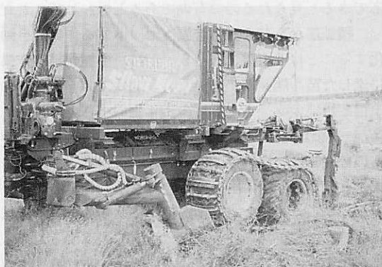
写真・1 フォワーダをベース車両としたスウェーデンの地拵え植栽機械シルバノバ（車体左右両脇に地拵え作業用のディスクトレンチャーがあり、Silva Novaと書いてある箱部分は苗積載ユニット。車体後部の後輪上に見える位置には作業機操作と苗のセットを行う作業機オペレータ室があり、車両最高端に植栽アームがある）
