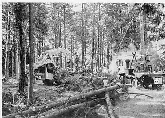
写真・7 タワーヤードによる集材
