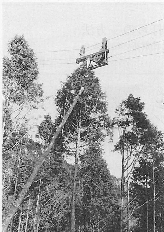
新索張り（SRS型）による岩大式集材法
