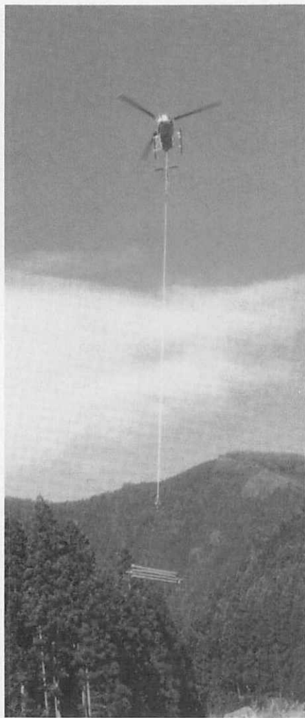
写真・1 ヘリコプター集材(アエロスパシアルSA 315 B型) (ジャパンロイヤルヘリコプター(株)提供)
