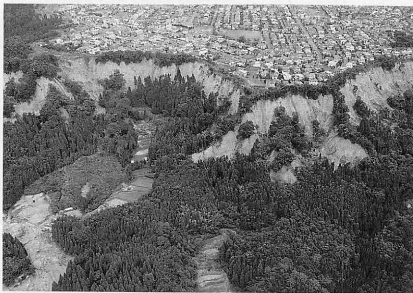
写真・シラス台地周縁部における斜面崩壊（始良ニュータウン）
