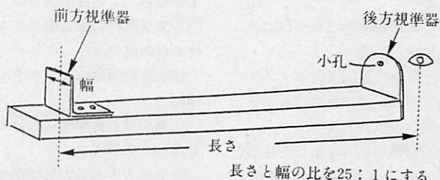
図・1 簡易計測器具の構造
