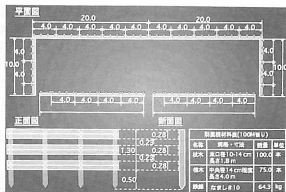
図・防風柵構造図
