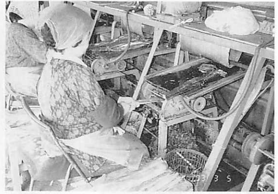
▲②コウゾの外樹皮を除去するための簡易な機械とその作業（遠藤氏宅にて）
