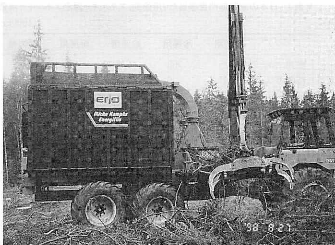
▲大型チッパーによる末木枝条の収集 チップ状になった木質バイオマスは専用コンテナに積み替えられた後、プラントまで輸送されます。
