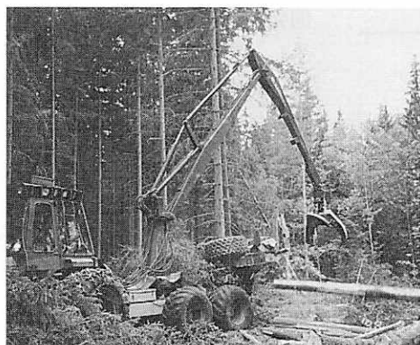
◀2 グリッパハーベスターによる伐木、造材の様子 この際、用材、パルプ材、末木枝条に分別されます。
