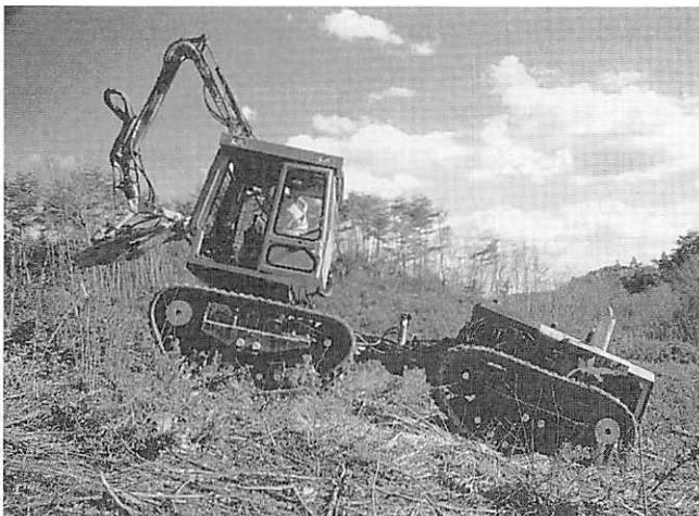
写真① 実用化に向けて山地で性能試験を重ねている 連結装軌式車両
