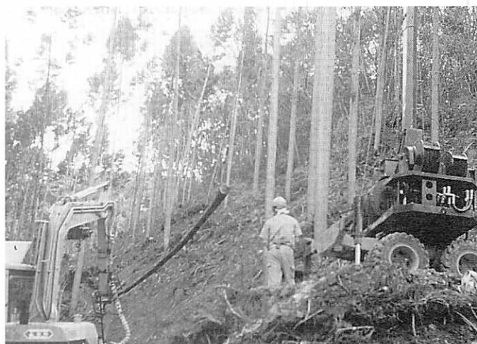
▲ 写真① 国産タワーヤーダとプロセッサ（枝払い・玉切り機械）の組み合わせ作業（注）：現在よく見られるこのような作業システムも、わずか10年前には存在していなかった。
