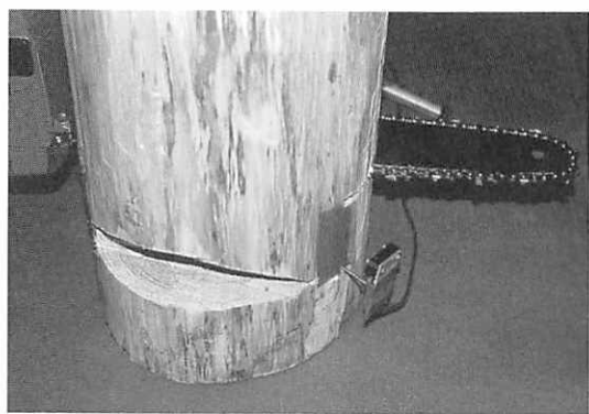
写真⑥ 2号機を取り付けた状態（追い口を切っていき、バーの歯の部分がセンサーの位置までくると確認ライトが点灯する）
