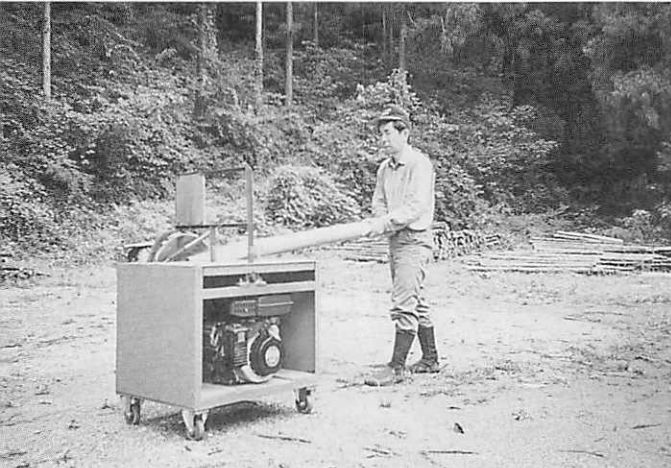
▲写真③ 丸鋸台を利用し杭作製中
