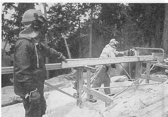
写真⑥ 山小屋づくりの資材をログソーで製材
