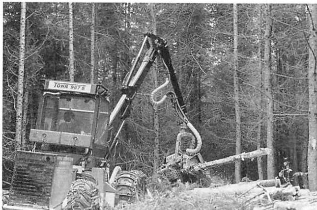
写真④ 林業専用車をベースマシンとするハーベスタ
