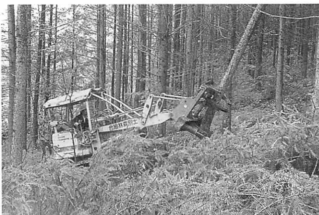
写真⑥ 小形のフェラーバンチャによる間伐作業
