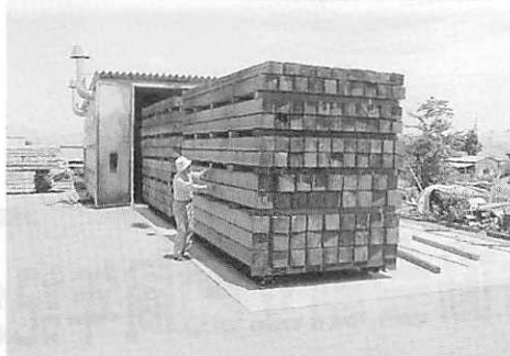
写真② 和田小学校 21 cm 角 カラ マツ柱の高温乾燥と 18 cm 角の仕上がり 柱（背割り材）
