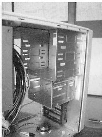
▲写真② 5インチ(上)と3.5インチ(下)のドライブを格納する場所(5インチベイ、3.5インチベイと呼ぶ)
