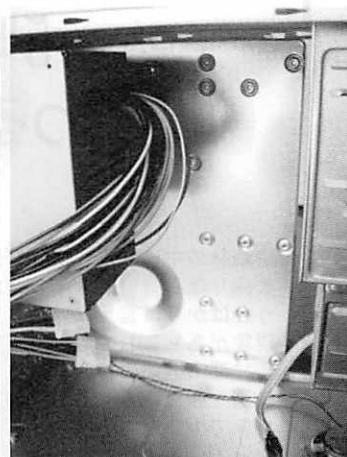
▲写真③ M/Bを取り付ける板(いろいろなM/Bに対応できるようにねじ穴がたくさんある)
