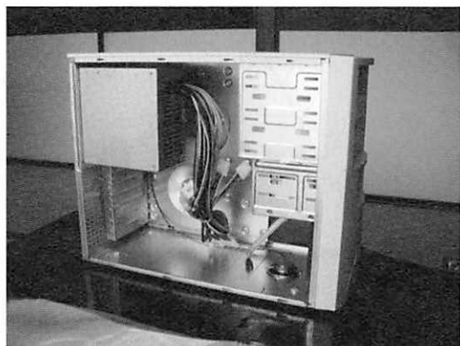
▲写真① ミニタワー型PCケースの全体 (左上が電源ユニット、右上がドライブを格納する場所、奥の板がM/B取り付け場所)
