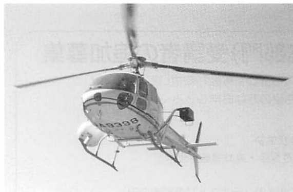
写真① 航空レーザー測距の運用状況。機体左側の直方体の箱がレーザー測距儀、右の球体がビデオカメラ
