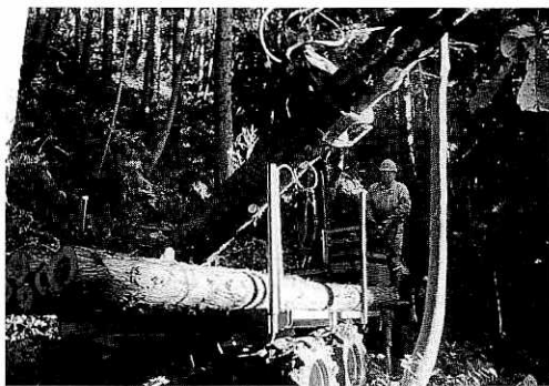
▲2t積みのフォワーダ(リョウシン号)のグラブブクレーンで集積作業中(自生したホオノキも見える)
