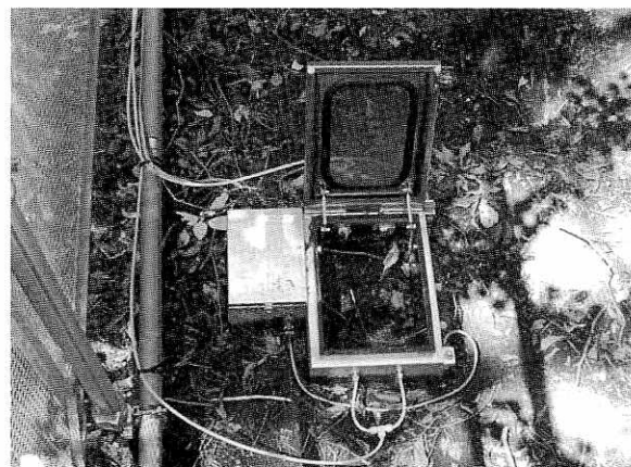
写真④ 自動開閉型の土壌呼吸量測定チャンバ(川越森林気象試験地)
