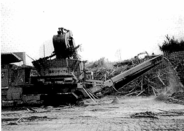
写真②の1 タブグラインダーにおける粉碎の様子
