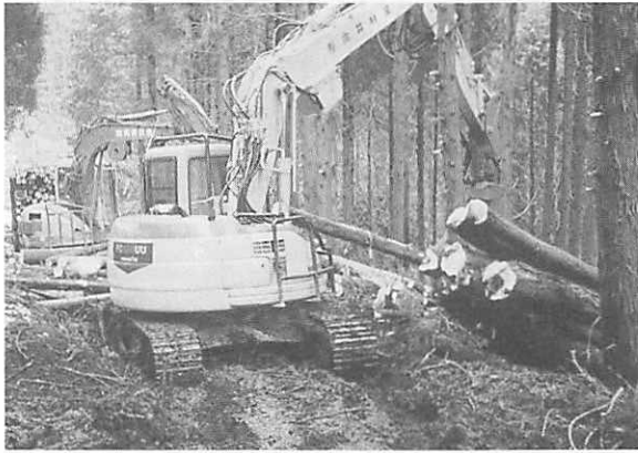
写真③ 小旋回ベースマシンによる造材・積み込み状況
