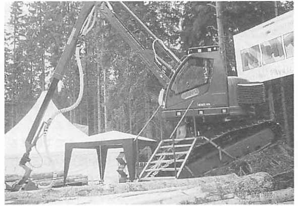
写真④ 上部旋回体を水平に保つテレスコームクローラ式ベースマシン (エルミアウッド 2003 にて)
