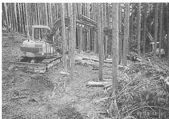
写真② スライドアームを装着した集材用グラップル
