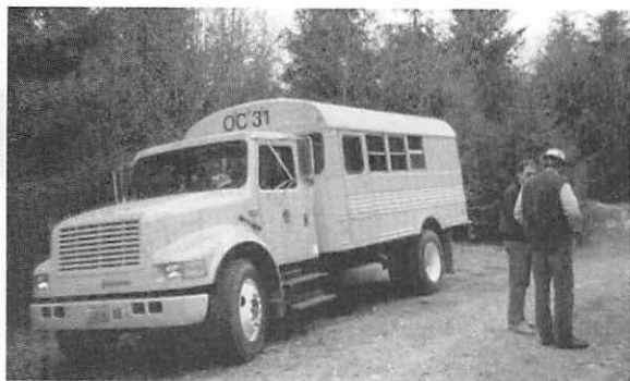
▲写真② 輸送バス。後部はチェーンソーなどの器具類収納庫となっている
