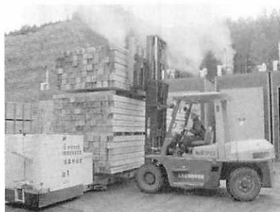
▲写真① 高温乾燥（蒸気式） 100℃以上の温度で、材表面にドラインゲットを形成して乾かします（外部加熱）。
