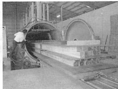
▲写真③ 高周波真空乾燥 高周波による内部加熱と真空（減圧）による沸点の低下を利用して乾燥します。
