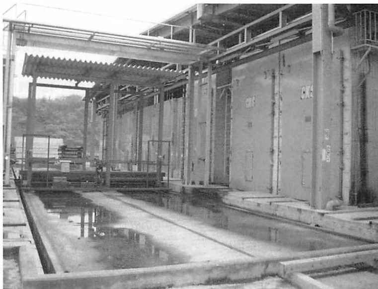
写真③ 久米工場の高温乾燥機 8 基。入口と出口が別にある
