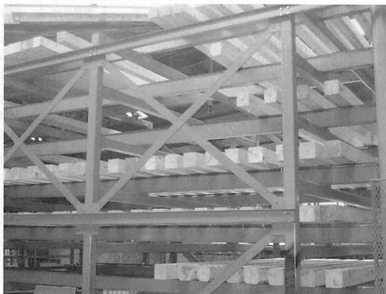
写真① 重量センサー通過後、グループ分けされてこの棚に入る
