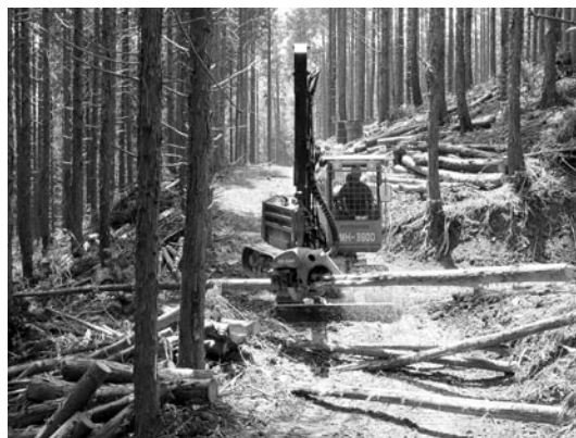
▲写真④ 集材路で造材を行うハーベスタ（美都町）
