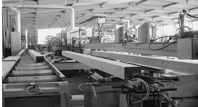
▲写真② 1日500本の修正挽きとグレーディング（水分と動的ヤング係数）をする最新鋭機
