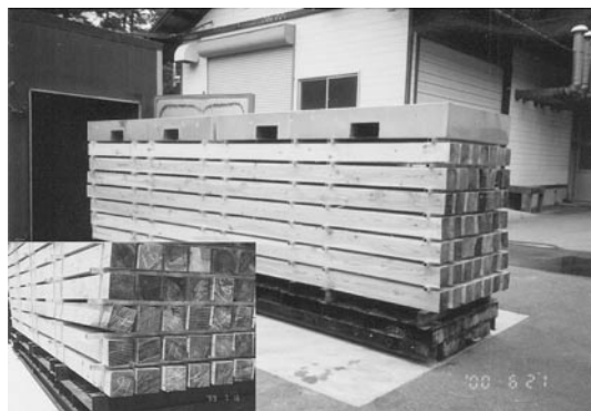
▲写真① 最高120℃で高温セット乾燥
