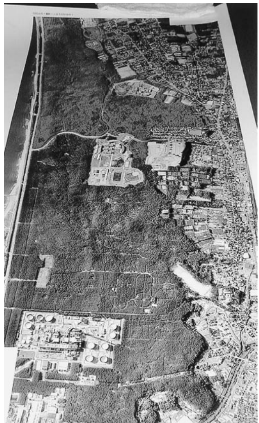
▲写真① 単写真を位置標定し、画像変換を行って作成された広域モザイク写真（秋田県秋田市近郊の海岸林。防除が行われているため比較的マツが残っている地域）
