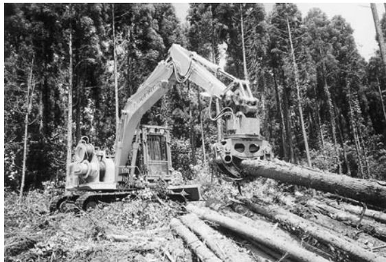
写真② スイニングヤードによる木寄せ・集材作業
