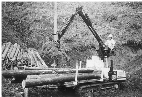
写真④ フォワーダによる積込・小運搬作業
