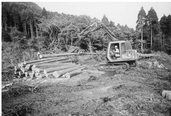
写真③ プロセッサによる枝打ち・造材作業
