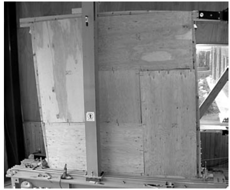
▲写真④ 針葉樹構造用合板の試験の様子
