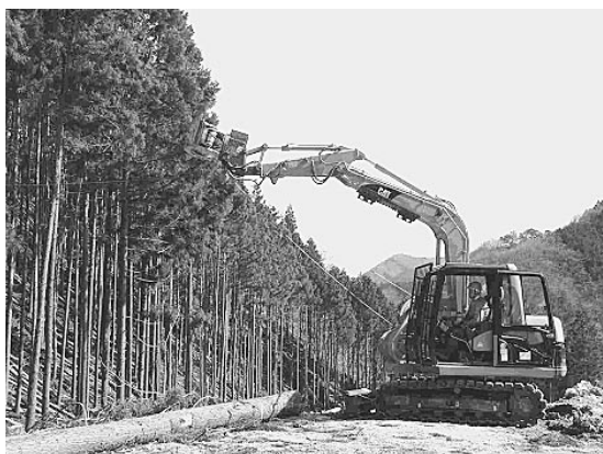
▲写真② こだま森林組合の素材生産作業システム (スイングヤーダによる集材)
