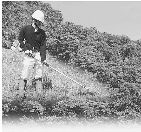
▲写真② 刈払機防護具（腰部分）を装着した作業員
