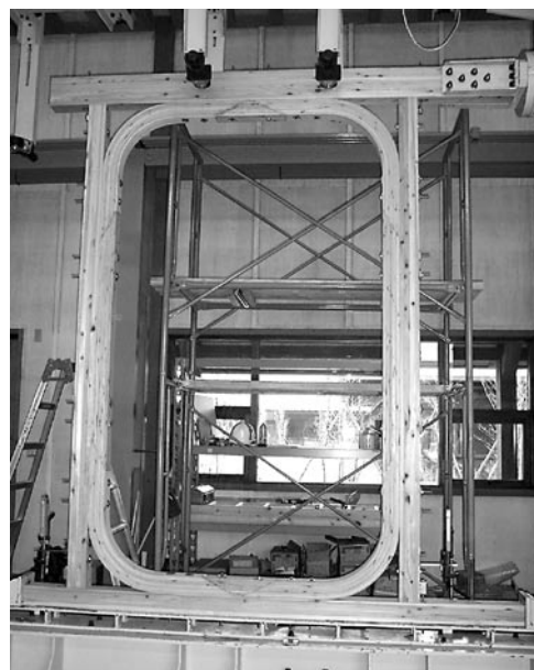
写真③ 湾曲フレーム実大壁せん断試験状況
