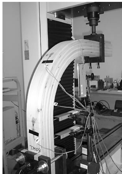
写真② 湾曲集成材強度試験状況
