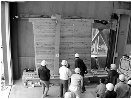
▲写真② パネル試験機に取り付けた試験体の様子 (右上の黒い部分が前後に動き、取り付けられた試験体を菱形に変形させます)
