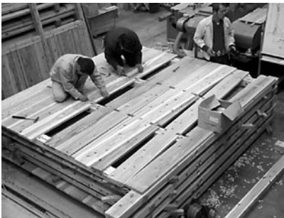
▲写真③ カシ材ダボ試験体の作製状況
