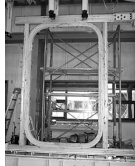
スギの湾曲フレーム実大壁せん断試験 (p.15)
