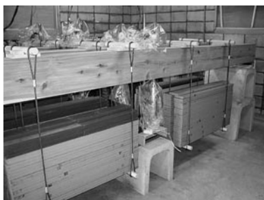
▶写真② スギ平角材の 曲げクリープ試験
