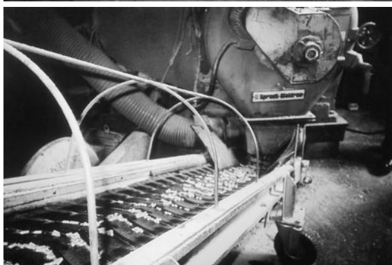
写真③ 葛巻町にあるペレット、チップの製造事業所（葛巻林業（株））。カラマツ間伐材からのペレット生産（写真下）
