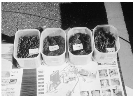
▲右から原料の樹皮、一次、二次破砕物、製品
