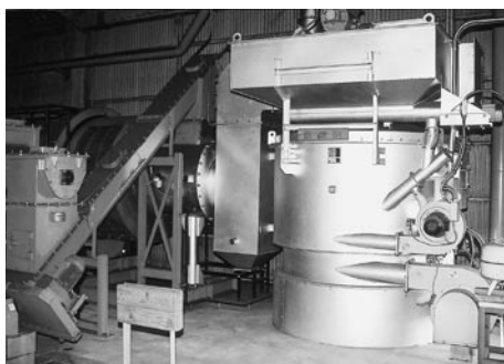
▲製造心臓部の燃焼機（右）と乾燥機（左奥）
