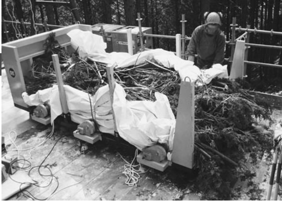
▲写真③ 運材コンテナを改良した簡易バンドラー （ヒノキの生枝条を圧縮した状態）
