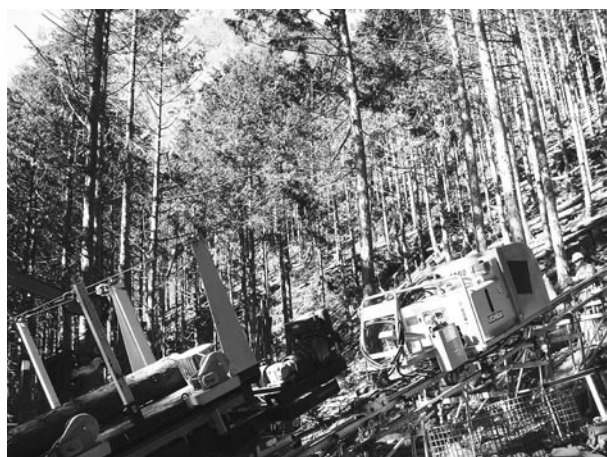
▲写真① 運材、車両系機械の搬入に用いる大型モノレールの機関車、運材コンテナと間伐林分
