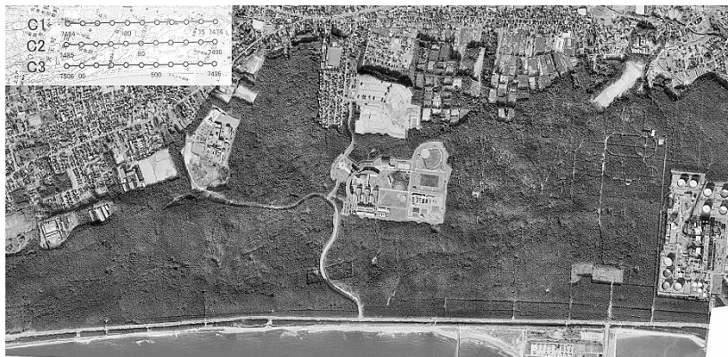
▲写真 撮影計画どおりに得られた写真評定図とデジタルモザイク写真 (解像度約 20cm の高分解能，地形図より正確です)
