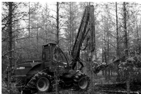
▲写真② ティンバージャック 870, 720 フェラーパンチヘッド付き
