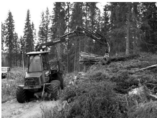
▲写真① 初回間伐での小径全木を林道端に積み上げる フォーワーダ
