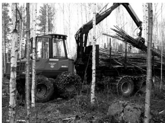
▲写真③ ヴァルメット 840.1, 広葉樹材の積み込み
