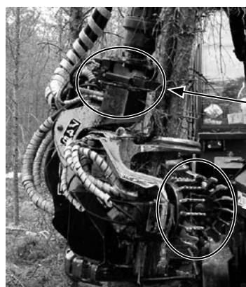
▲写真⑥ ティンバージャック 745 ハーベスタヘッド、多種作業ヘッド
