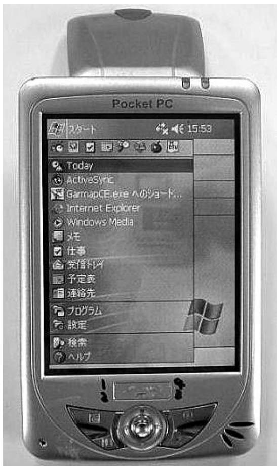
▲写真① Mio168 の外観 (GPS アンテナを起こした状態)
