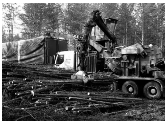
▲写真⑤ 林道端での全幹材のチップ化作業
