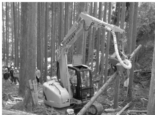
▲自動的に玉切り(寸法をそろえる)もできる林業機械の作業
