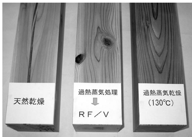
▲写真② 乾燥終了後の材面の色あいの比較（参考までに天然乾燥の場合と比べてください）
