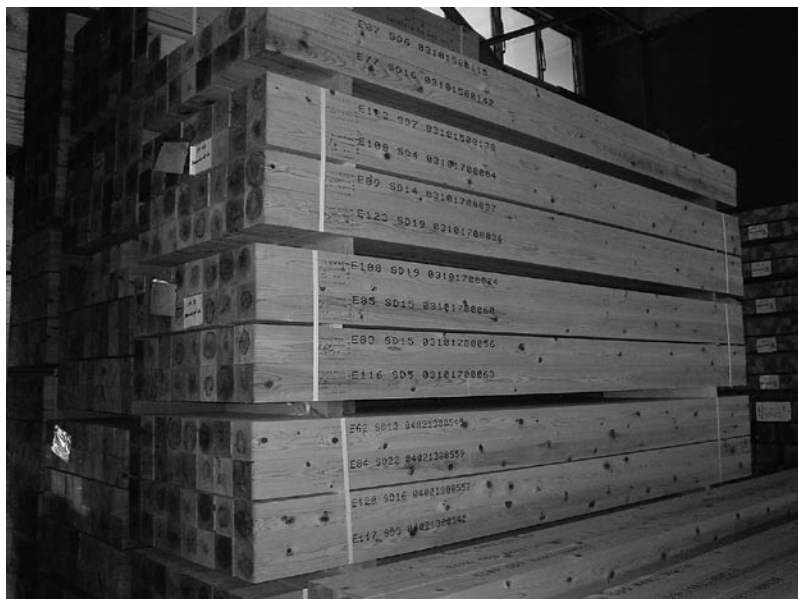
▲含水率、強度が明示されたスギ柱材（しかし非 JAS 品である）
