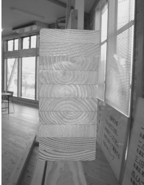
▲ハイブリッドビームのサンプル(最外層の上下2枚ずつがベイマツで内層がスギ)
