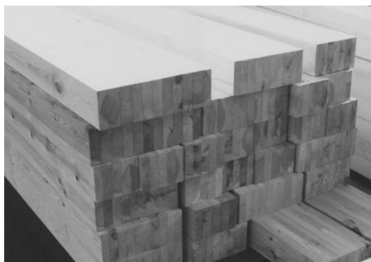
▲根太レス工法の普及で需要が増加している集成平角
