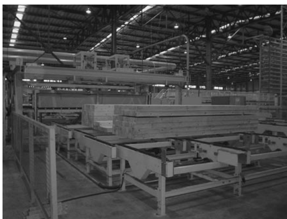
▲茨城県内のプレカット工場の部材投入口（品質チェックの必要がない集成材を利用しているので、チェック用の人員を配置する必要がなく、その分のコストを浮かせることができる）
