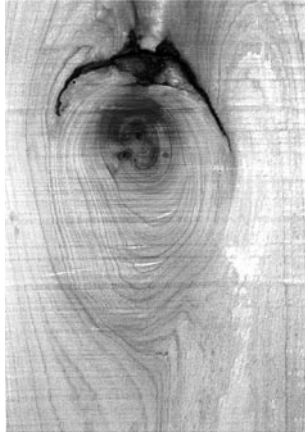
▶写真① 板目面における入皮節
