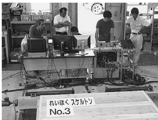
▲「れいほくスケルトン」の構造性能を検証するため、高知県森林技術センターにおいて、各種強度試験を実施。
